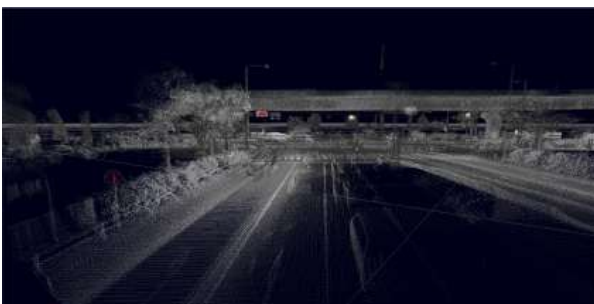
レーザーで取得した点群情報
